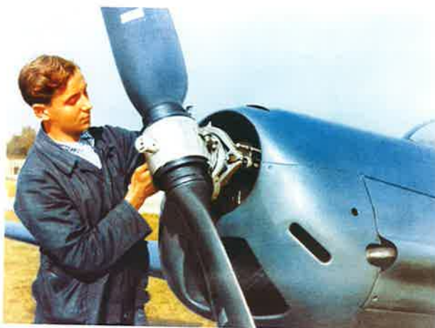
Rechts: Kontrolle an der Verstellschraube beim Propeller Me P7 vor dem Abflug einer Bf 108.
